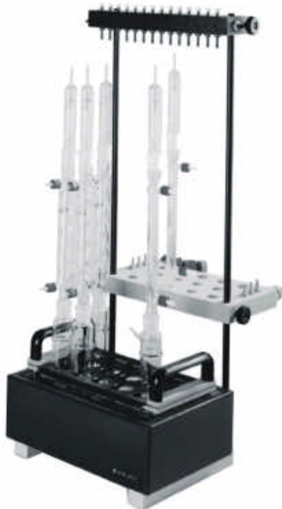
Reaktions- Heizblock für 14 Reaktionsgläser mit separater Zeit- und Temperatursteuerung (analoge Sollwertanzeige, digitale Istwertanzeige bis 200°C, Schnittstellen- Option für Prozessautomatisierung und Datendokumentation)
